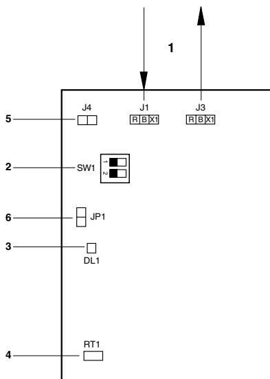
1. Terminais de ligação com o termóstato DPC ou com outra sonda AS1.
