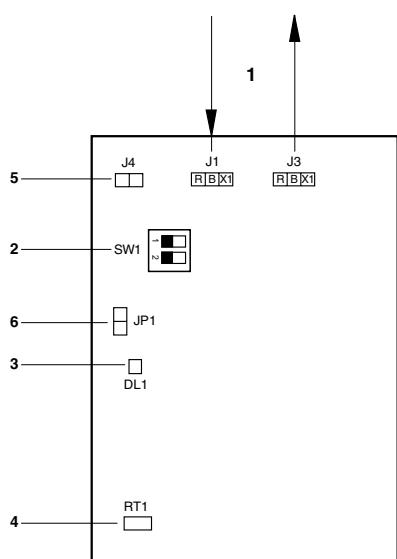
1. Klemmen zum Anschluss des Thermostats DPC oder eines anderen Sensors AS1.
