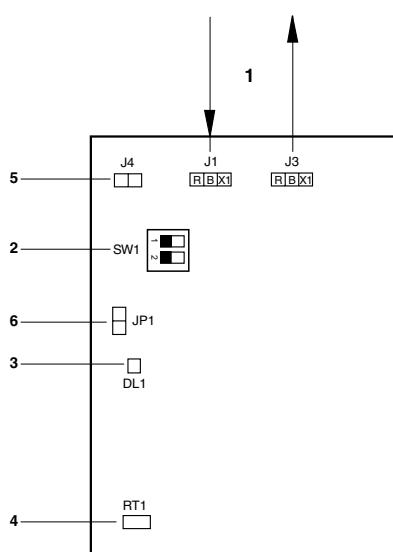
1. Terminales de conexión con el termostato DPC ó con otra sonda AS1.
