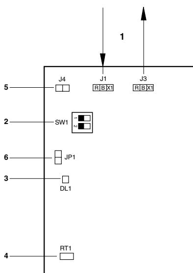
1. Morsetti di collegamento con il termostato DPC o con un'altra sonda AS1
